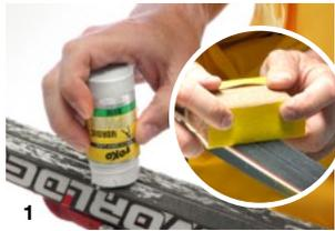
Gripzone mit Waxremover oder Gel Clean gut reinigen. Gleitzone mit Masking Tape abkleben.
